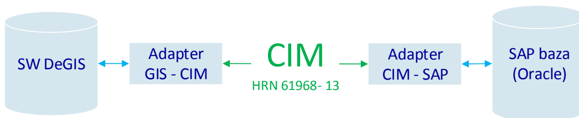
Slika 4. Ilustracija integracije SW DeGIS i SAP sustava
